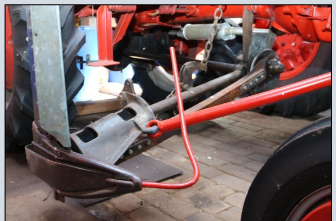
Detail van de maai balk onder de Farmall Cub
