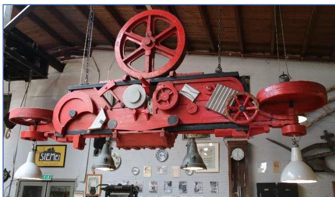
Mallen om gietvormen te maken voor wielen
