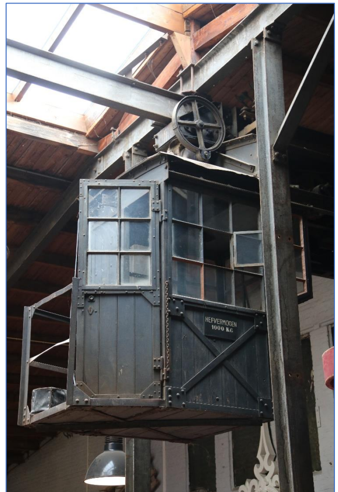
Cabine van de bovenkraan
