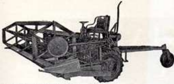
PLATAFORMA HILERADORA "CMC" Aplicada al chasis tractor, 16 pies de corte. Descarga al centro mediante dos lonas de tela engomada. Su patín de acero permite trabajar casi a ras del suelo.
