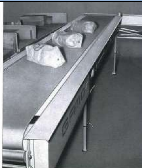
Stat. Förderbandanlage für Kartoffel- lagerhäuser bei der Tütenkartoffelför- derung.
