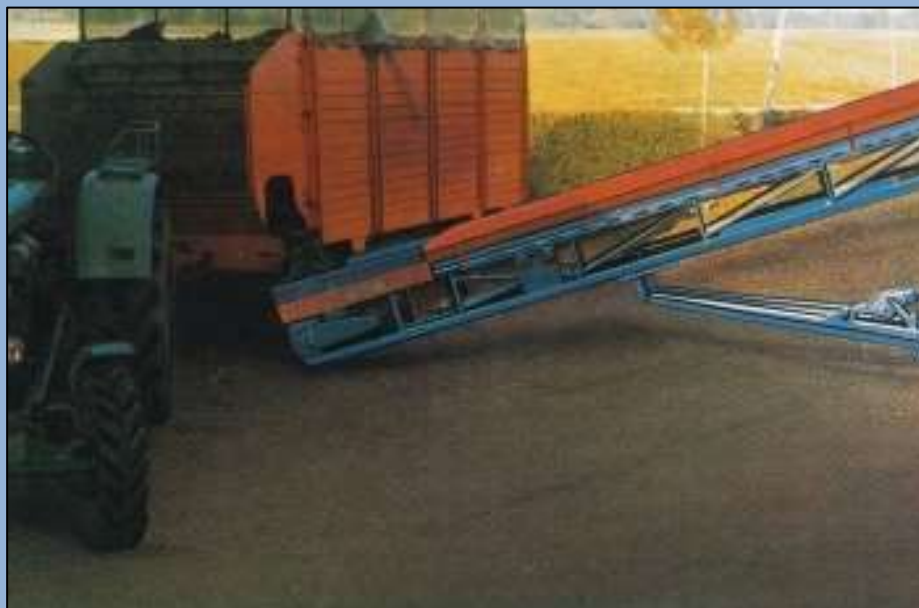
GAMO-Düngerschleuderband angebaut an ein Flexowellband. Das Schleuderband ist höhenverstellbar wodurch verschiedene Reichweiten erzielt werden.
