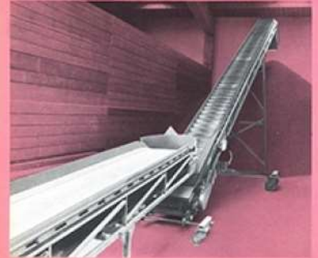
GAMO-Flexwellförderband mit Spezial-Fahrgestell bei der Düngereinlagerung.
