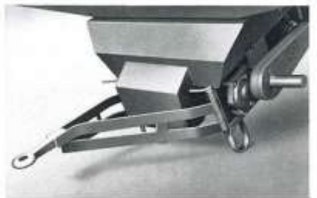
Anhängerkupplung durch Steckbolzenbefestigung leicht abnehmbar.
