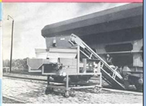
GAMO-Wiegeband elektronisch gesteuert für losen Dünger, Futtermittel und Getreide.
