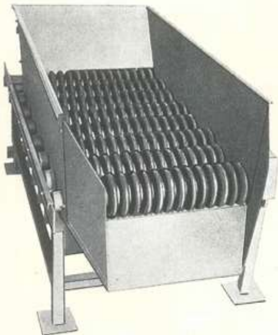
GAMO Kartoffelscheibenent-erder für verletzungsfreie und für schonende Kartoffelenterdung
