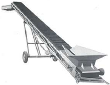
GAMO-Düngerschleuderband angebaut an ein Flexowellband. Das Schleuderband ist höhenverstellbar wodurch verschiedene Reichweiten erzielt werden.
