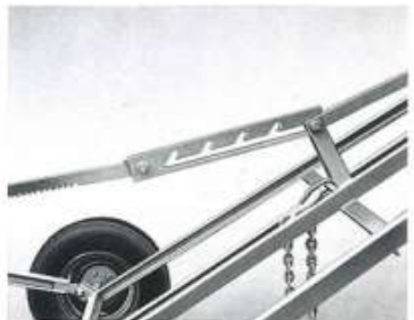
Fahrgestell Typ Z mit Zahnstangenwinde und Patentverstellung.
