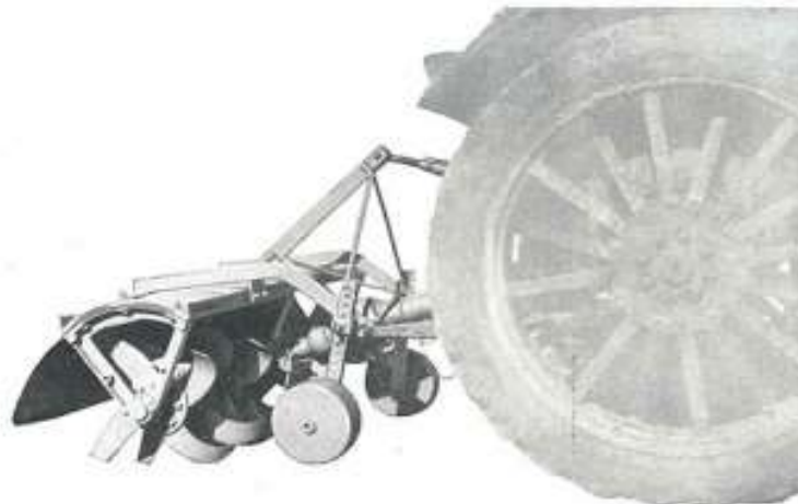
RK 15, RK 17 und RK 19 mit Sylicium Mangan-Stahl-Messern
