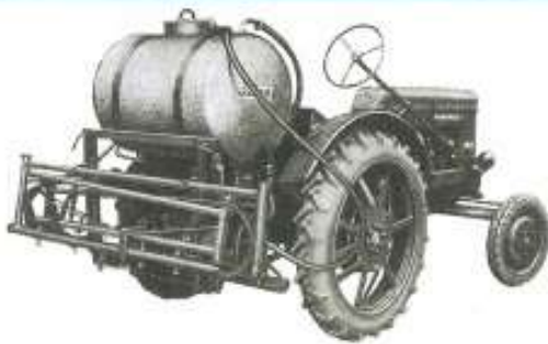
MAUSER Aufsattelspritze für Schlepper mit Dreipunkt-Hydraulik
