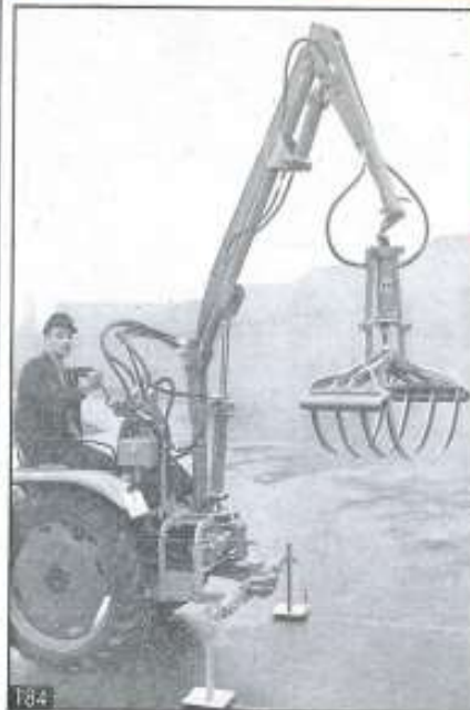
Vollhydraulische Hecklader HL für alle Schleppertypen von 10-60 PS, auch mit hydraulischer Abstützung.
