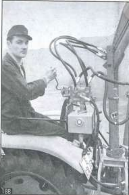
Vollhydraulische Hecklader HL für alle Schleppertypen von 10-60 PS, auch mit hydraulischer Abstützung.
