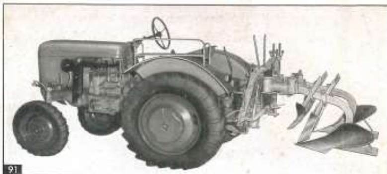
Schlepper mit PRINTZ-Hydraulik und einscharigem Wechselflugsatz
