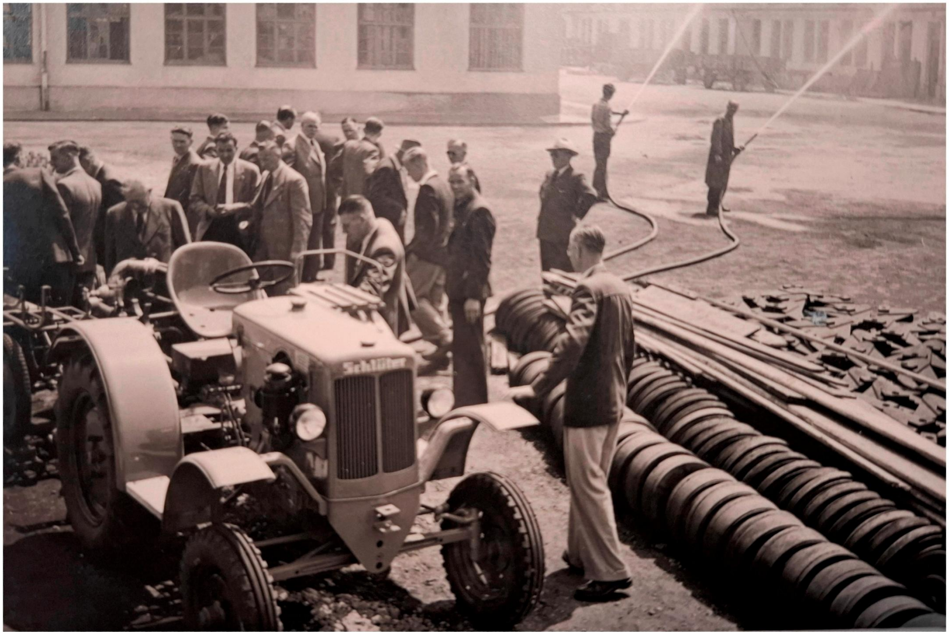
Schlüter met pomp aangedreven via aftakas
